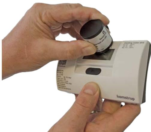
Bei längerdauernden Datenauslesungen, bei der Auslesung der Datenlogger, oder wenn der optische Auslesekopf aus anderen Gründen am Zähler fixiert werden soll, kann ein transparenter Halter hierzu verwendet werden (siehe Abschnitt 3.2.3).
