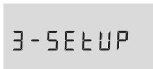
Die SETUP-Schleife wird dadurch gewählt, dass die Taste 9 Sekunden lang gedrückt gehalten wird, bis in der Anzeige "SETUP" angezeigt wird.
