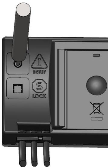
Der Zähler bleibt in der SETUP-Schleife, bis die Fronttaste 5 Sekunden lang gedrückt gehalten wird jedoch sichert ein Timeout, dass der Zähler nach 4 Minuten vom SETUP-Schleife zum Normalmodus zurückkehrt.
