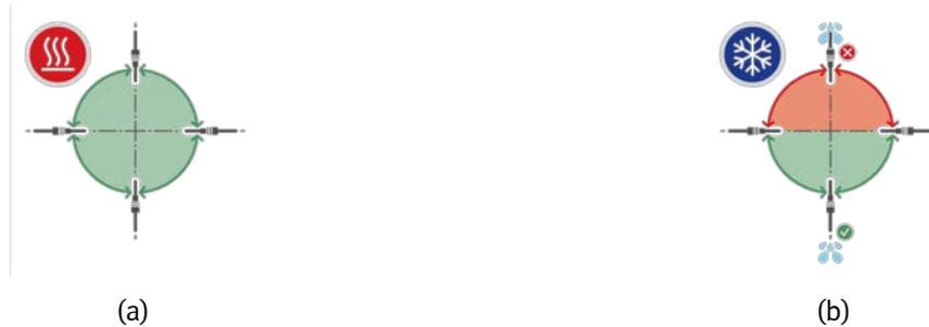
Abb. 5. Akzeptable Orientierung eines Temperaturfühlers in (a) einer Wärme- und (b) einer Kälteinstallation.
