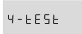
Der Zähler bleibt im Test-Modus, bis die Fronttaste 5 Sekunden lang gedrückt gehalten wird, jedoch sichert ein Time-out, dass der Zähler nach 9 Stunden vom Test-Modus zum normalen Modus zurückkehrt.
