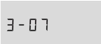
Beachten Sie beim Ändern der Einstellung der Energieeinheit, dass die Änderung die ersten Ziffern in der Anzeige beeinflussen kann. Wenn Sie z.B. GJ mit 2 Dezimalen in GJ mit 3 Dezimalen ändern, verschwindet die erste Ziffer. Dies gilt auch beim Ändern von kWh ohne Dezimalen zu kWh mit 1 Dezimale. Und im entgegengesetzten Fall verschwindet die am wenigsten wichtige Ziffer, wenn Sie beispielsweise kWh mit 1 Dezimale in 0 Dezimalen ändern. Siehe die Beispiele unten:
