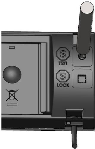
Bevor der Zähler auf Test-Modus eingestellt werden kann, muss die "TEST"-Plombe (S) hinten am Zähler vorsichtig mit einem Schraubenzieher gebrochen werden, und die Klemmstellen hinter der Plombe müssen mit dem Kurzschlusswerkzeug, Typ 66-99-278, kurzgeschlossen werden.
